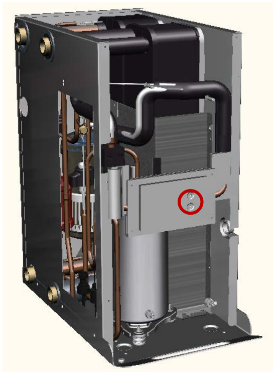
Steg 17. Demontera kylplatta för inverter (Torx T20).
