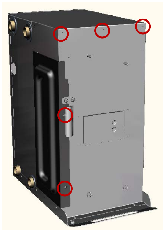
Steg 15. Demontera tak och servicelucka till kylkrets (Torx T20).
