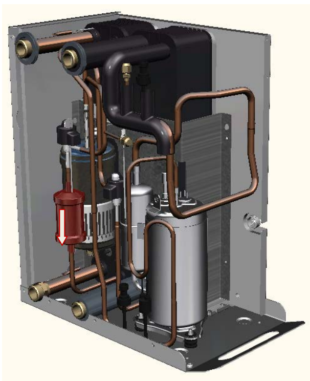
Steg 24. Montera kompressor. Löd torkfilter och kompressor. OBS! Använd nitrogen som skyddsgas och kyl expansionsventil med våt trasa under lödning. Flödesriktning torkfilter nedåt.
