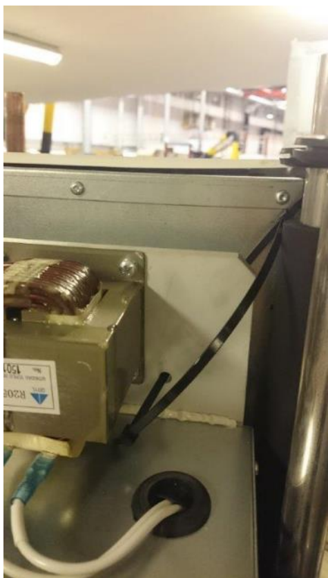
Steg 11. Lossa invertern i uppkant. Montera 2 st buntband i serie.
