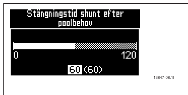
Bild 8 Väg: Meny\Pool\Poolshunt\Shuntens stängningstid
