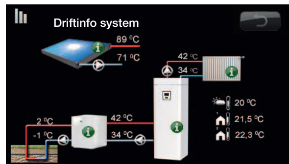
Bilden visar driftinformation med CTC EcoPart ansluten. När pumparna är i drift så roterar även pumpsymbolerna på bilden.
