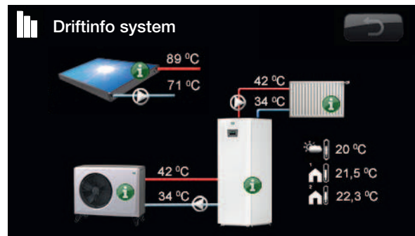
Bilden visar driftinformation med CTC EcoAir ansluten. När pumparna är i drift så roterar även pumpsymbolerna på bilden.
