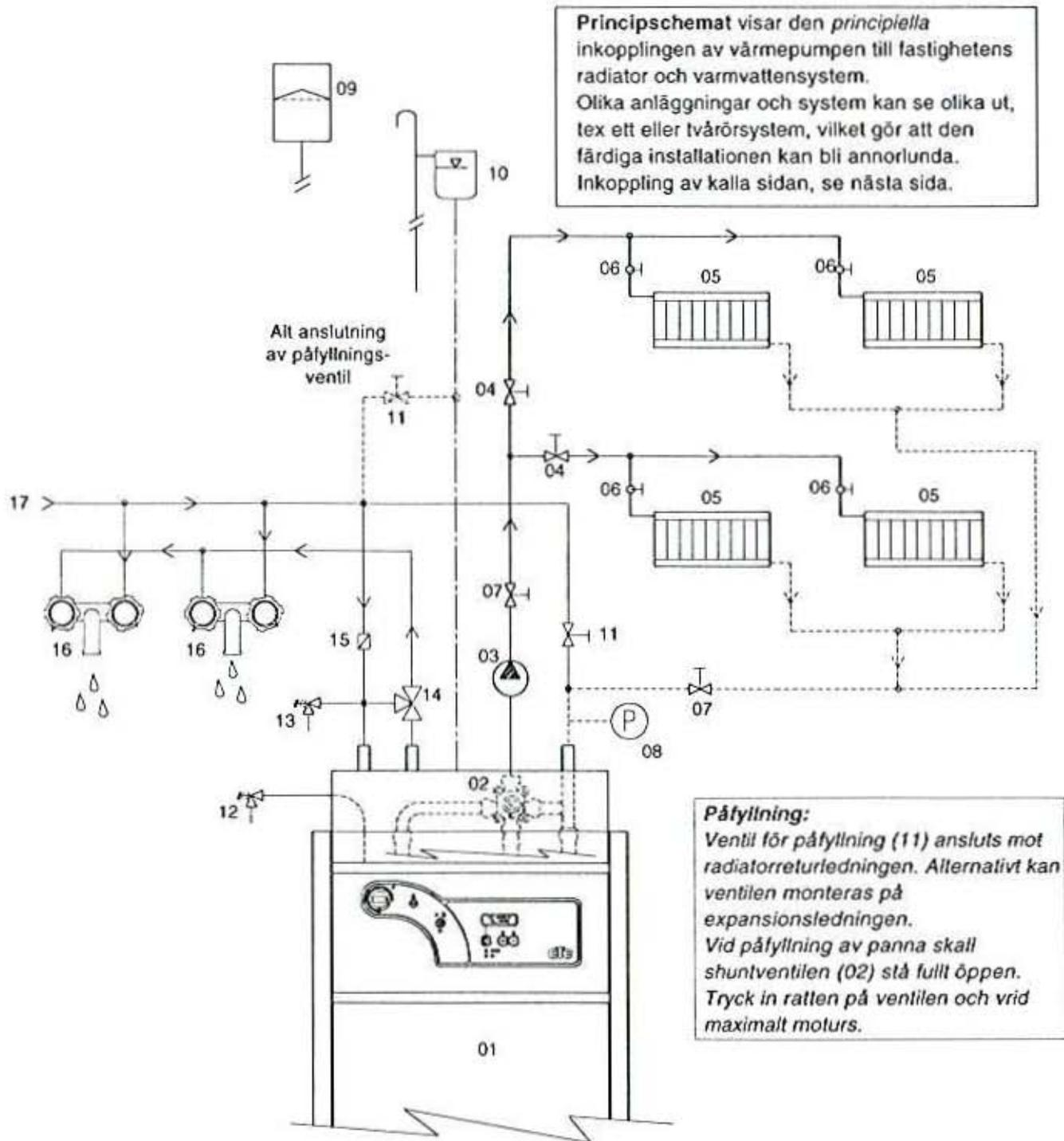
**Principskemat** visar den *principiella* inkopplingen av värmepumpen till fastighetens radiator och varmvattensystem. Olika anläggningar och system kan se olika ut, tex ett eller tvårörssystem, vilket gör att den färdiga installationen kan bli annorlunda. Inkoppling av kalla sidan, se nästa sida.
