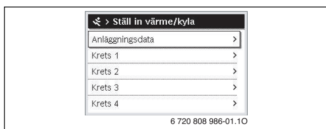
Bild 42 Menyn Inställningar för husvärme
